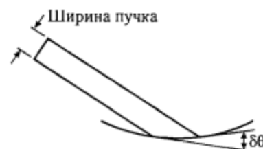
Рис. 3.4. Изменение угла падения поперек пучка на искривленном образце.
