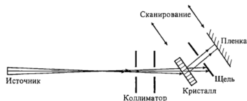
Рис. 8.5. Схема установки для проекционной топографии.
