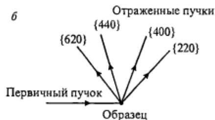
Рис. 4.8. Дифракционный эксперимент с поликристаллическим образцом.
