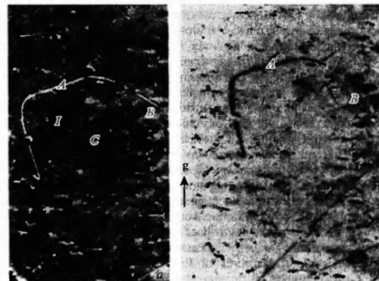
Рис. 9.4. Экспериментальные топограммы в геометрии Брэгга, полученные от объемного кристалла InP на одной из сторон кривой качания: малоугловой (а), большеугловой (б) [4].
