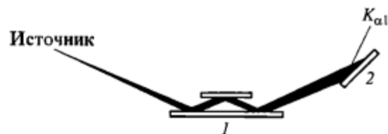
Рис. 2.16. Коллиматор пучка с прорезным каналом (1) в комбинации с кристаллом-монокроматором (2). (Конструкция Таннера и Боуэна).
