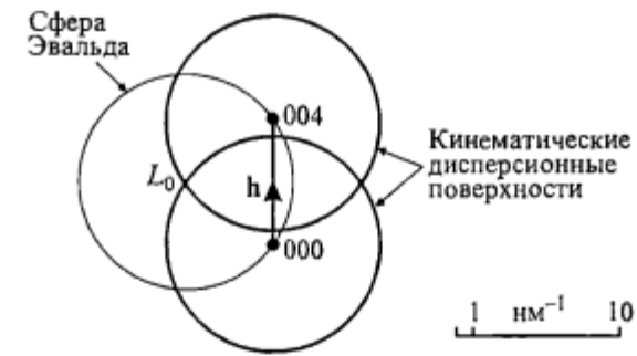
Рис. 4.11. Кинематическая дисперсионная поверхность. (Показано сечение сферы Эвальда).
