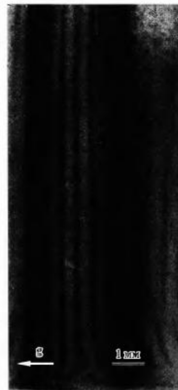
Рис. 9.7. Двухкристальная топограмма, полученная для искривленной пластины GaAs с несколькими эпитаксиальными слоями AlGaAs, которая показывает развертку эффективной кривой качания в изображение [10].
