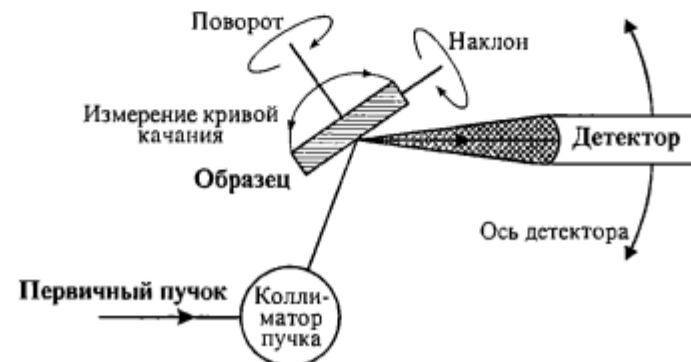
Рис. 2.4. Схема высокоразрешающего двухосевого дифрактометра.
