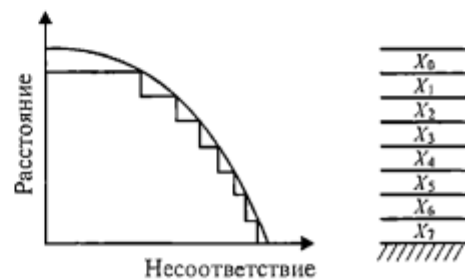
Рис. 6.5. Приближительное представление непрерывного изменения параметра решетки в виде последовательности ламелей ( X_0 — X_7 ) с постоянным параметром решетки.
