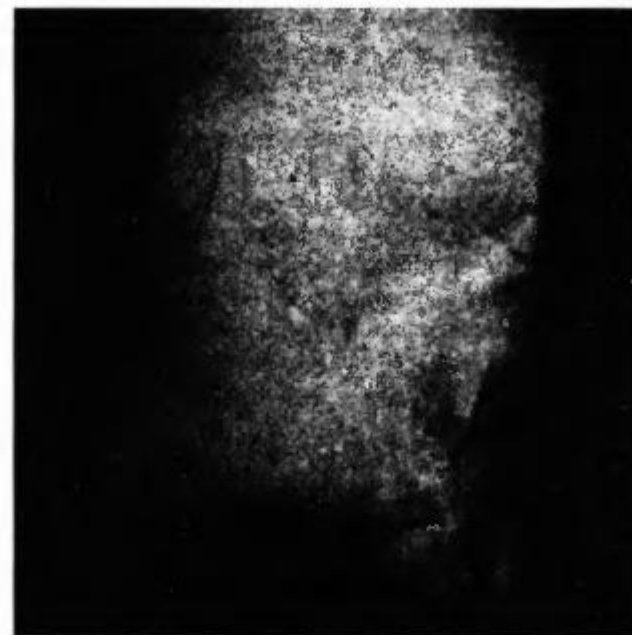
Рис. 1.8. Двухкристальная топограмма кристалла GaP, полученная в \text{Cu } K_{\alpha 1} -излучении от обычной рентгеновской трубки мощностью 1 кВт.
