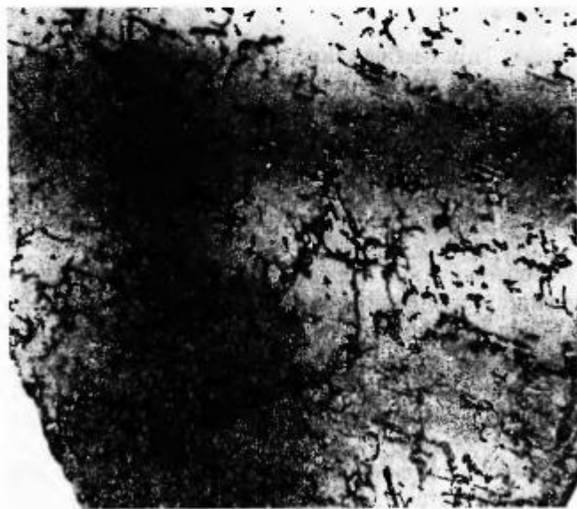
Рис. 1.7. Топограмма Ланга (на прохождение) пластины кремния, полученная в \text{Mo } K_{\alpha 1} -излучении ( \lambda = 0.07 \text{ нм} ) от обычной рентгеновской трубки.
