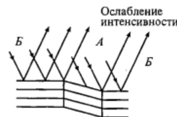
Рис. 8.1. Ориентационный контраст в условиях монохроматизированного коллимированного рентгеновского пучка.
